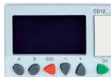
Mini PLC - Pic. 3
